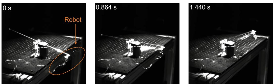
図 2 ロボハチドリ信州の高高度飛行環境模擬下のリフトオフ実験の高速度カメラ撮影画像。東北大学流体科学研究所所有の火星大気風洞の減圧チャンバーを利用した。チャンバー内の大気密度は飛行高度 9000 m に相当する  $0.360 \text{ kg/m}^3$  である。ロボットの羽ばたき周波数は 10.9 Hz、カメラのサンプリング周波数は 2000 fps である。ロボットは羽ばたき開始後 0.864 秒後にはリフトオフし、1.440 秒後には初期位置から約 167.4 mm 上昇した。地上モデルは羽ばたき周波数 22.7 Hz でリフトオフすることが可能である。
