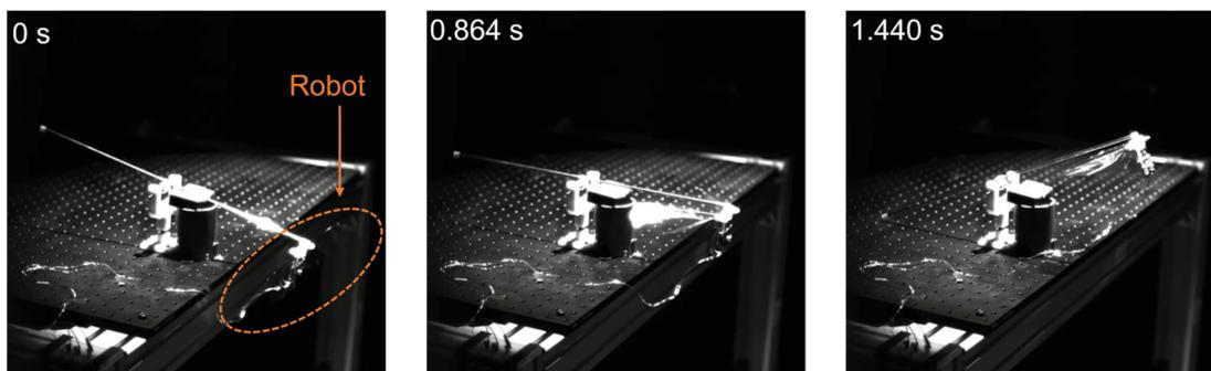
図 2 ロボハチドリ信州の高高度飛行環境模擬下のリフトオフ実験の高速度カメラ撮影画像。東北大学流体科学研究所所有の火星大気風洞の減圧チャンバーを利用した。チャンバー内の大気密度は飛行高度 9000 m に相当する  $0.360 \text{ kg/m}^3$  である。ロボットの羽ばたき周波数は 10.9 Hz、カメラのサンプリング周波数は 2000 fps である。ロボットは羽ばたき開始後 0.864 秒後にはリフトオフし、1.440 秒後には初期位置から約 167.4 mm 上昇した。地上モデルは羽ばたき周波数 22.7 Hz でリフトオフすることが可能である。
