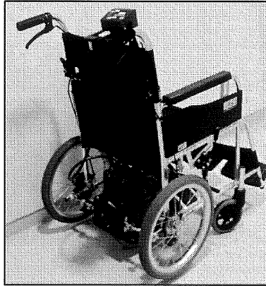
図 1. 開発した電動駆動ユニットを市販の車いすに取り付けた様子
