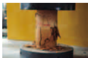
円柱供試体の強度試験
