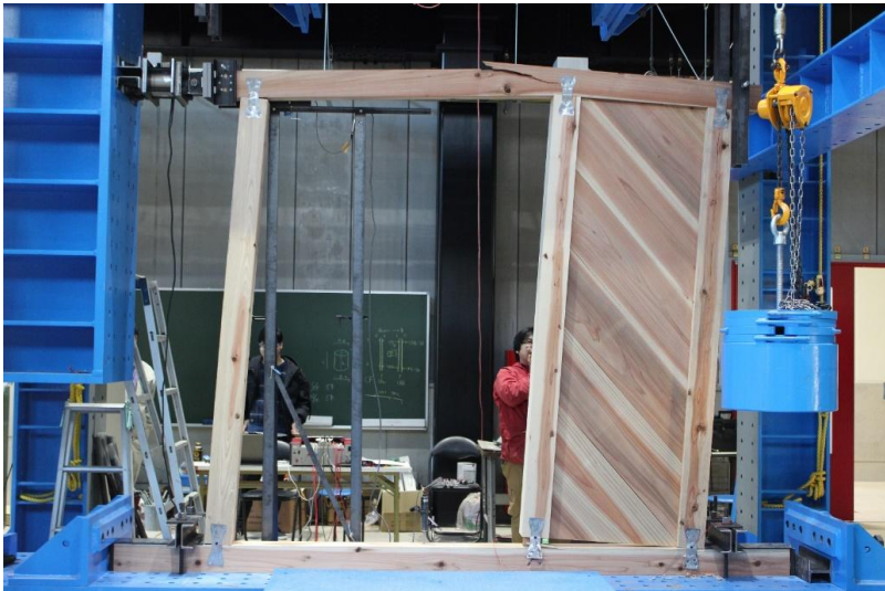
群馬県産材木造パネルの耐震性能実験
